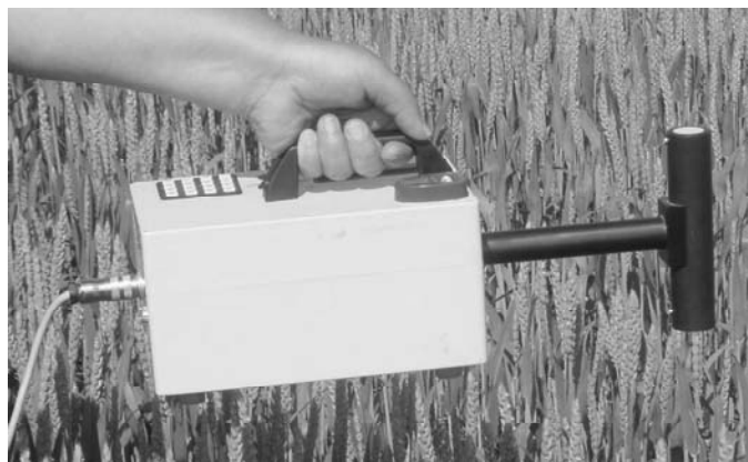
Abb. 1: Bestandesbonitur mittels handgehaltenem Zweikanalspektrometer im Winterweizen
