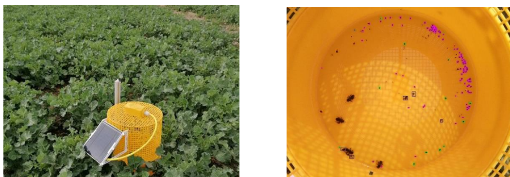
Fig. 1: Digitale Gelbschalen im Raps (BBCH 50) Fig. 2: Bilderkennungsalgorithmus
