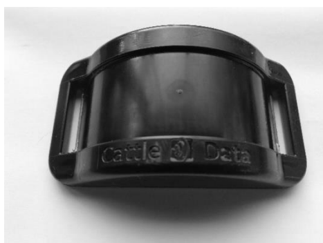
Abb. 1: Gehäuse des neu entwickelten Lokalisierungssystems (im Detail links) im Einsatz im Stall (oben am Halsband rechts).
