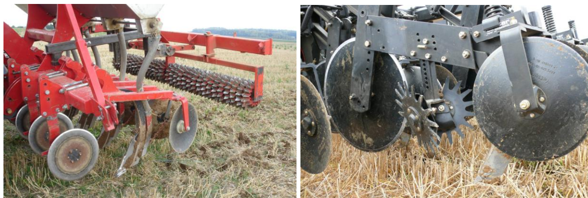
Abb. 2: Streifenlockerer Horsch Focus Prototyp (links) und Yetter Maverick mit Räumsternen (rechts).
